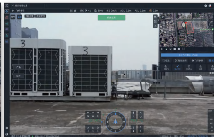
支持 pc 端、摇杆超视觉远程控制无人机行动、控制负载等
