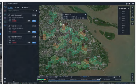
无人机执行任务过程中，实时采集信号数据绘制城市电磁态势
